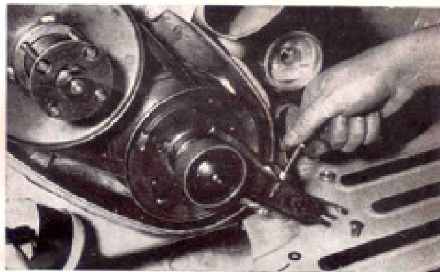
Figure A. — Démontage du goujon de fixation de la fourchette de débrayage.
