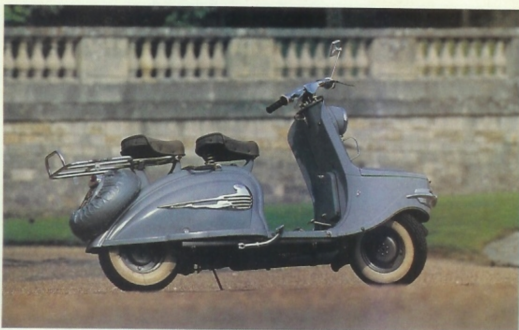
Les sièges mono-place du S.55 sont plus confortables que la selle bi-place du Cezeta. Comme le CZ, le Peugeot peut se mettre en route au kick starter ou au démarreur électrique.
