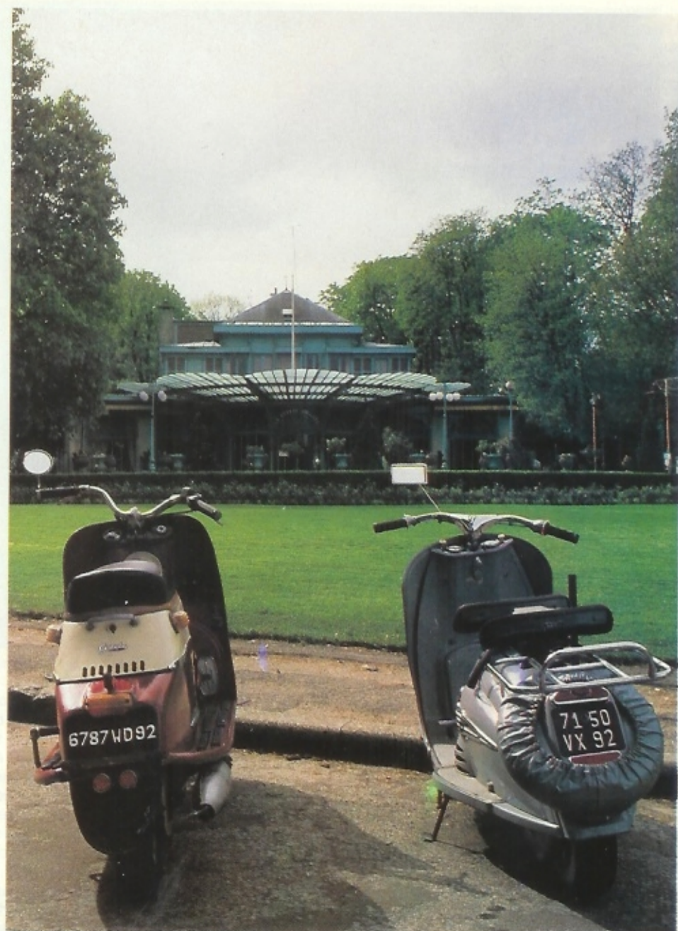
Sur le Cezeta né en 1957, les clignotants ne sont apparus qu'en 1960, tout comme le démarreur électrique et les amortisseurs hydrauliques. La roue de secours du Peugeot est une option.
