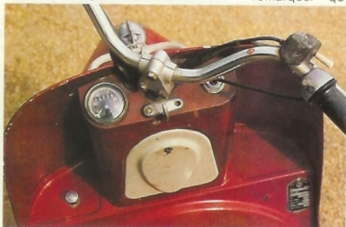
Compteur, contacteur, commande des clignotants, de phare, de klaxon, crochet de sac: le CZ bénéficie d'un équipement complet pour l'époque.
