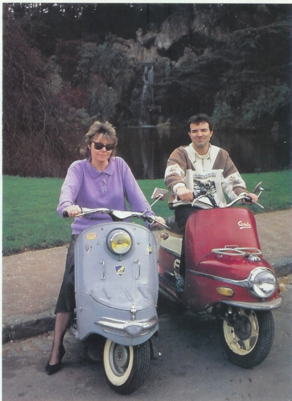
Avec leur avant prononcé, ces deux scooters possèdent une ligne très semblable. Si l'avant du Peugeot cache un coffre, celui du Cezeta abrite un réservoir de 11 litres.
