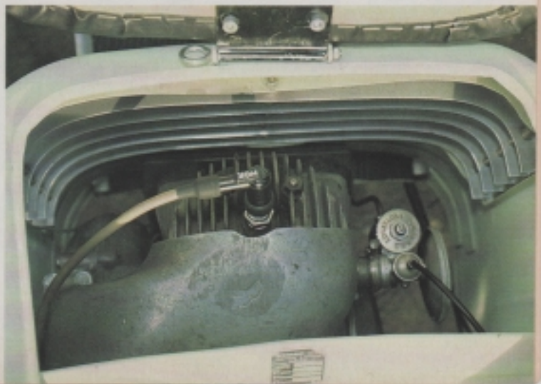
Le moteur à refroidissement par air était conçu par YDRAL.
