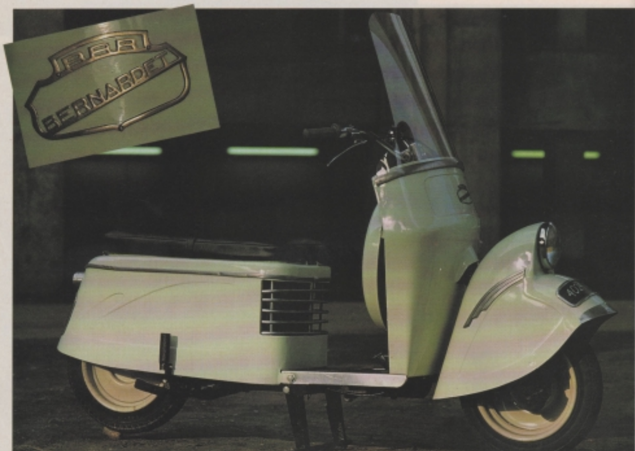
Le Bernardet fut présenté lors du Salon de Paris de 1948. La roue de secours (derrière le tablier avant) est bien protégée par son couvercle en tôle.
