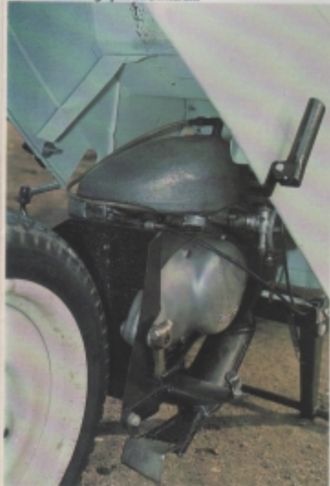
Un ensemble moteur performant dont l'Alésage x Course était de 54 x 55 mm.
