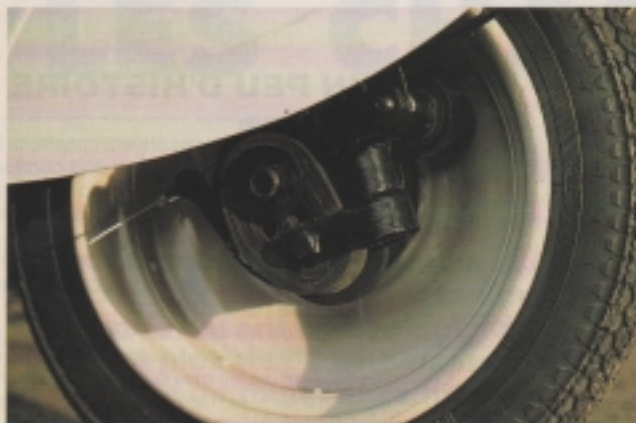
Le moyeu avant a un diamètre de 20 mm alors que celui du tambour de frein est de 130 mm. Les roues sont en 12" et sont chaussées de Dunlop 4,00 x 12. Pression de gonflage conseillée: 1,2 à l'avant et 1,3 derrière.
